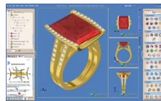
Функция Draft Kit помогает построить 3D-модель по эскизу
